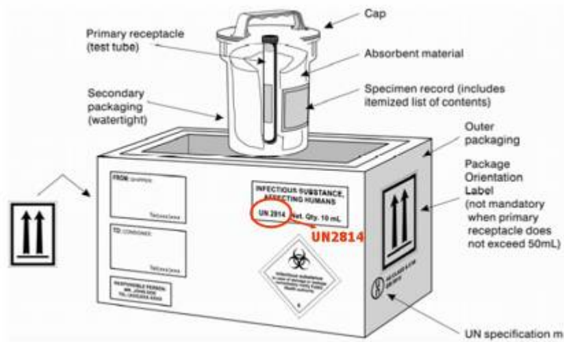
รูปที่ 6 การบรรจุเชื้อแบบ UN2814 สำหรับเชื้อโรคใน category A ซึ่งสามารถก่อโรคในคนได้
